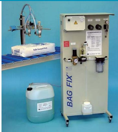
BAG FIX™ ESP-2 предлагает широкую палитру возможностей всех систем BAG FIX™: от нанесения валиком – губкой, войлоком до точного распыления. Световая клавиша распознает упаковочный предмет и программирует управление пистолетами нанесения. Насос с двойной мембранный пропускает GRIP FIX™ через фильтр к пистолетам, которые контролируются при помощи оповещения о холостом ходе и посредством регулятора давления.
