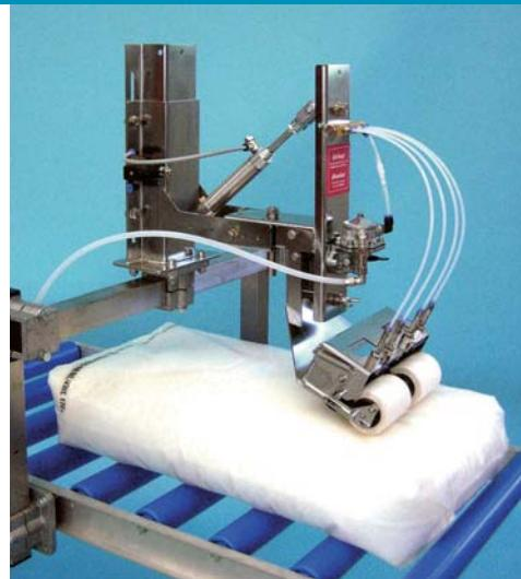
Данная механическая система функционирует без подачи энергии. Ленточный конвейер, транспортирующий мешки, приподнимает рукав нанесения с обоими валиками. По этой причине активизируется механически мембранный насос, который распределяет GRIP FIX™ между 4 насадками губчатого или войлочного валиков.
