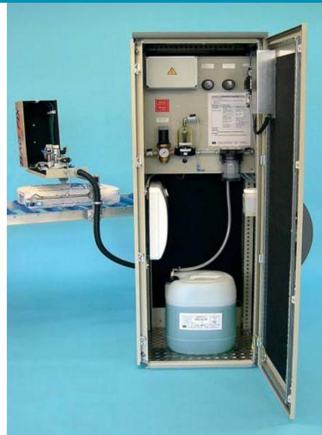
Данная система разработана специально для неотапливаемых производственных помещений до -20C. Световая клавиша распознает упаковочные предметы, на которые наносятся 0,5–2,0г GRIP FIX™.
