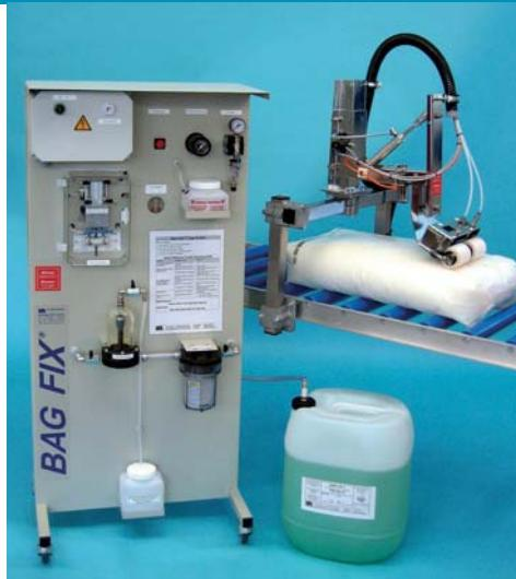
ПЭ-мешок приподнимает наносящий валик, при этом запускается сигнал накачки. Небольшая масса 0 – 0,2г GRIP FIX™ наносится войлочными или губчатыми валиками на поверхность мешков.
