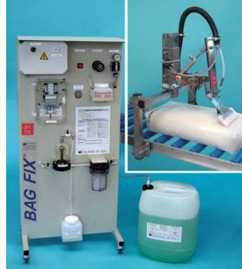
Ленточный конвейер, транспортирующий мешки, приподнимает рукав нанесения с войлочной секцией, что вызывает в действие сигнал насоса. Небольшая масса 0 – 0,2 г GRIP FIX™ наносится войлочной секцией на поверхность мешков.
