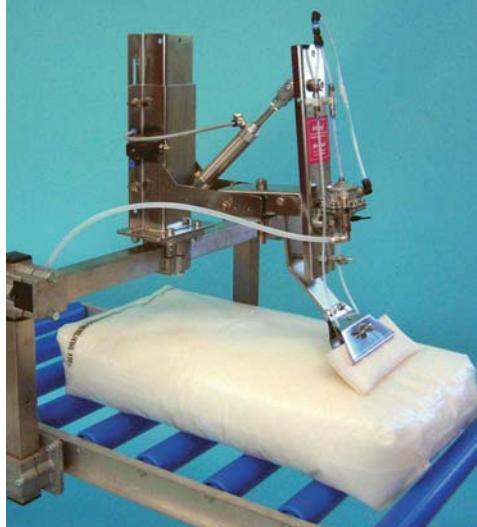
Данная механическая система функционирует без подачи энергии. Ленточный конвейер, транспортирующий мешки, приподнимает рукав нанесения с войлочной секцией. По этой причине активизируется механически мембранный насос, который распределяет GRIP FIX™ на войлочную секцию.
